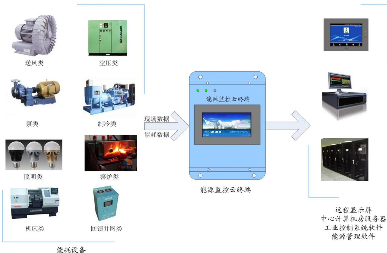
图 1 能源监控云终端的监测功能
